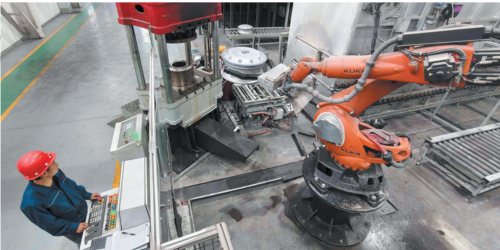
旋压工序机械手自动化上料
