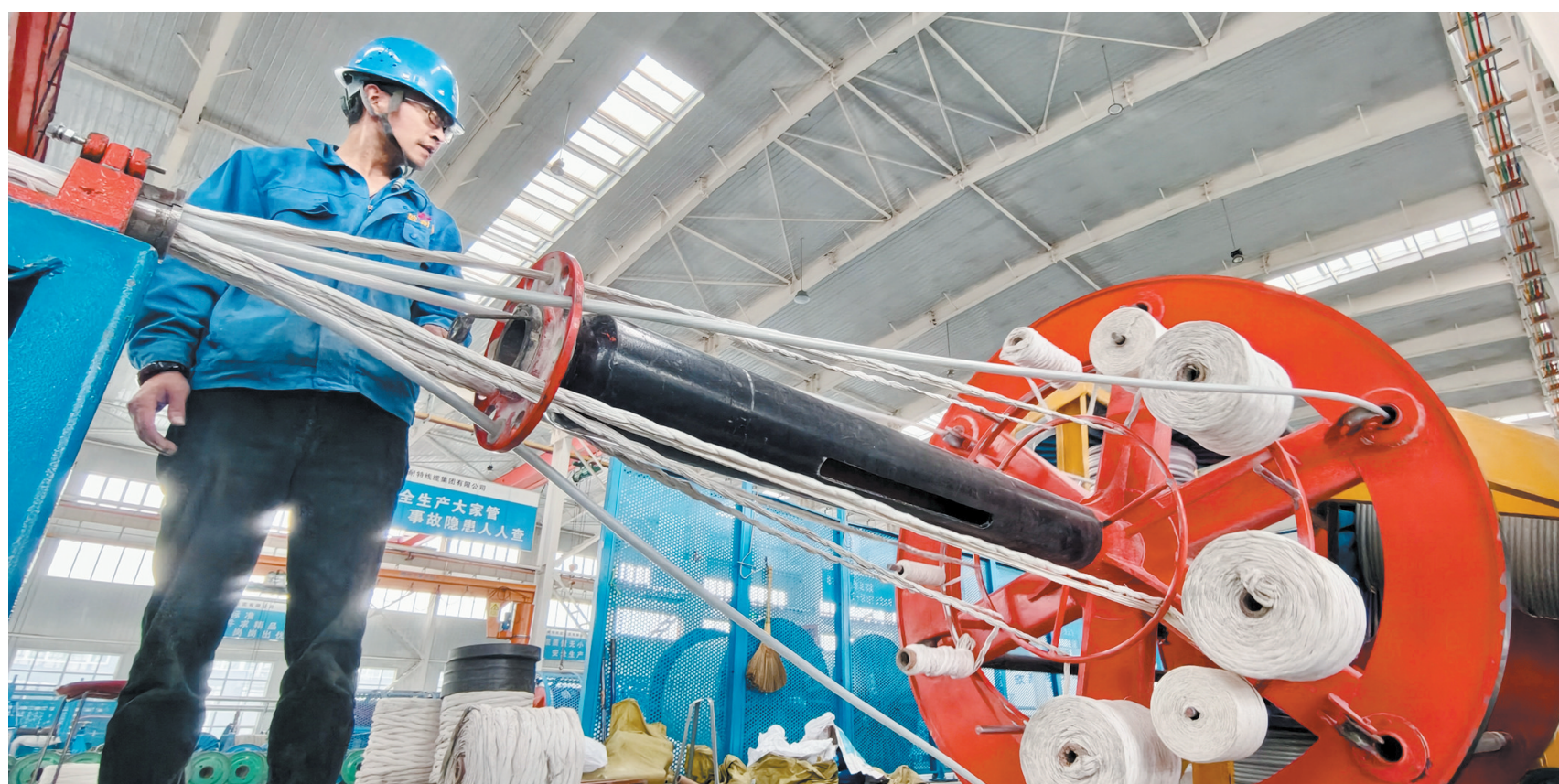
中压成缆工序在成缆电缆
