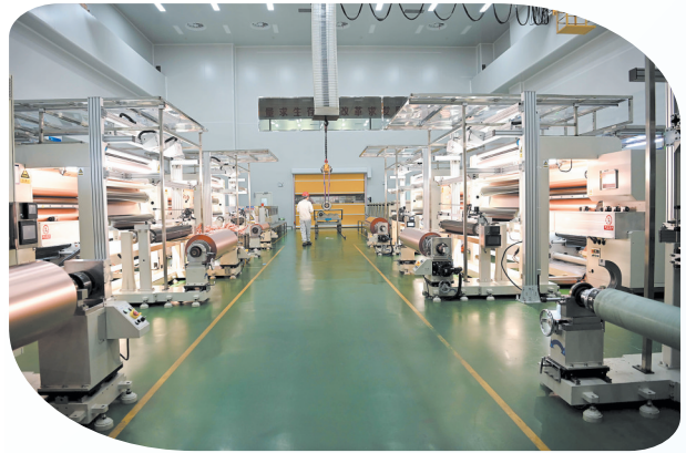
青海诺德新材料有限公司微米级薄锂电铜箔生产车间。 本报记者 陆广涛 摄
