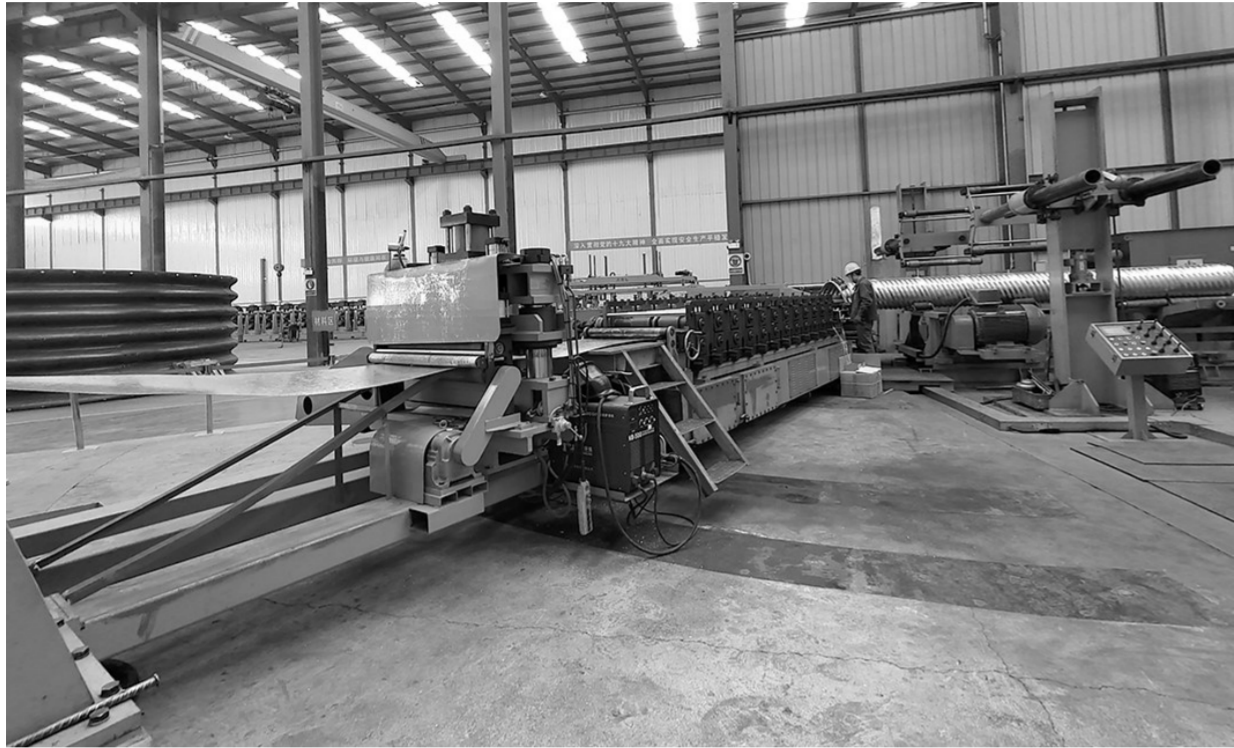
波纹管的车床仅需一人操作。
