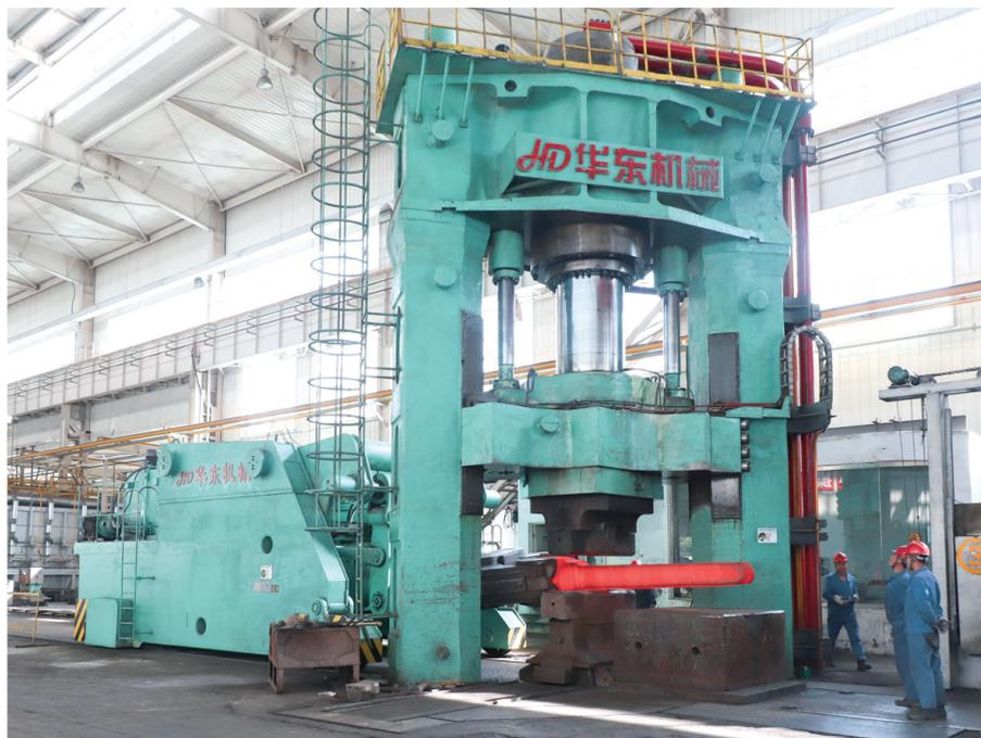
2500T快锻机组,配备25T操作机,具备连续锻和快锻功能,主要用于各类材料的自由锻件生产。中钛青锻供图
