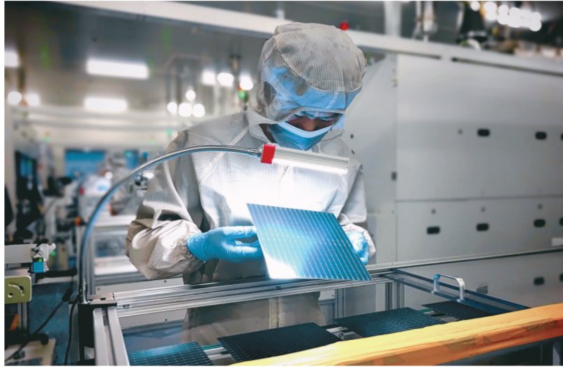
操作员查看电池片丝网印刷的质量。
