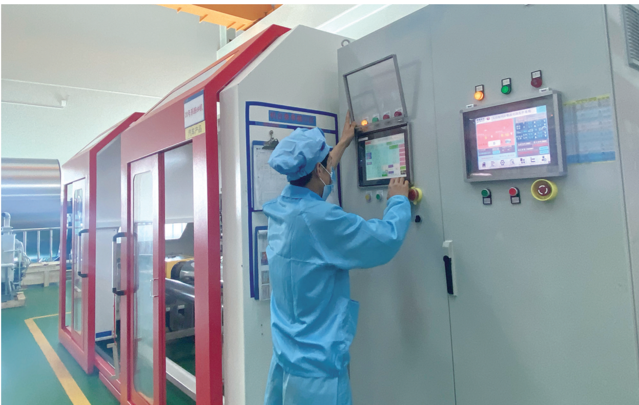
工作人员操作生箔机控制系统。
