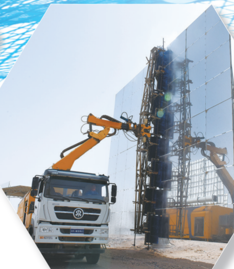
鲁能新能源(集团)有限公司定日镜清洁维护中。
