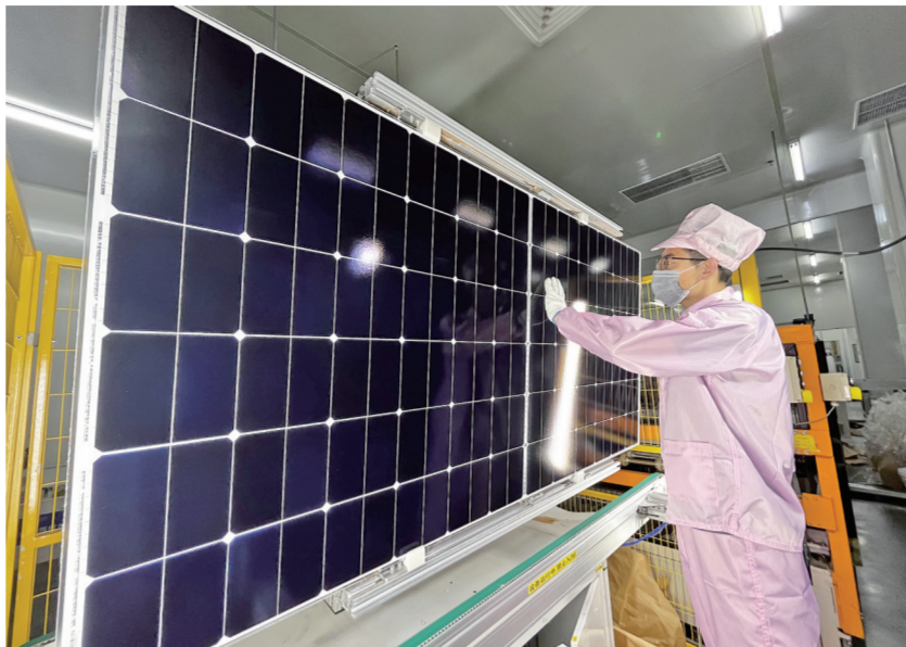
IBC组件生产车间工作人员正在工作台检验外观。 黄河公司供图
