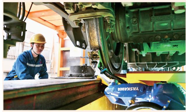
4月29日，在中国铁路青藏集团有限公司西宁机务段检修车间，以往的人力探伤已转变为机器人探伤。据了解，探伤机器人不仅精准、灵活，还拥有智慧大脑，在探伤过程中，类似“脑电图”一样的检测波形会实时传输至电脑端，便于分析人员随时掌握信息。图为探伤机器人上线。
