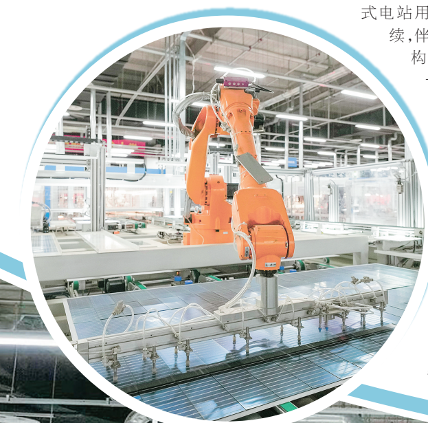
▼天合光能机械臂加工光伏板。 天合光能供图
