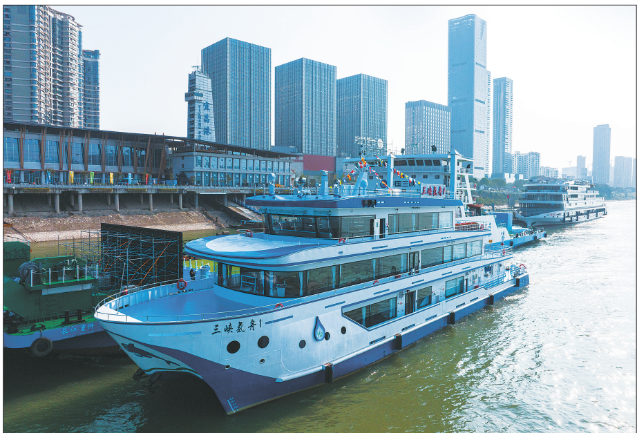
10月11日，启航前的“三峡氢舟1”号停靠在湖北宜昌三峡游客中心（无人机照片）。我国首艘氢燃料电池动力示范船“三峡氢舟1”号11日在长江三峡起始点湖北宜昌首航。这标志着氢燃料电池技术在我国内河船舶应用实现零的突破。据测算，“三峡氢舟1”号相比传统燃油动力船舶，预计每年可替代燃油103.16吨，减少二氧化碳排放343.67吨。
